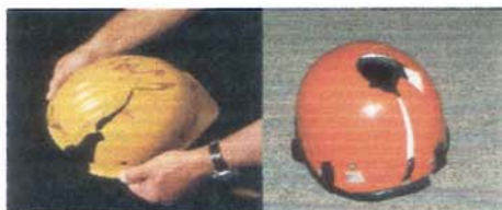
Abb. 10 + 11 Folgen von Helmen aus nicht alterungs- oder kältebeständigem Kunststoff
